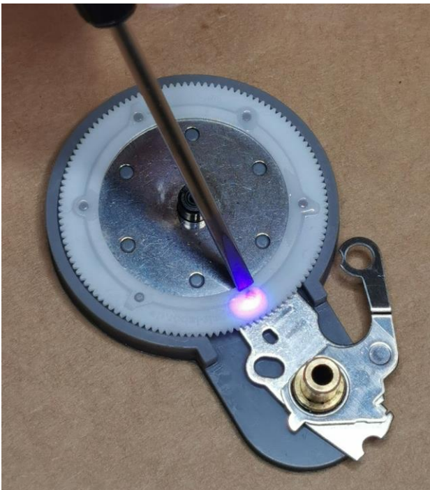
Bild 18 Aushärtung der Klebestellen mit einem UV-Laser
