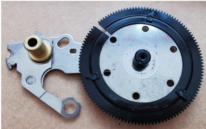
Bild 10 Trägerbaugruppe mit dem gebrochenen CenterGear
