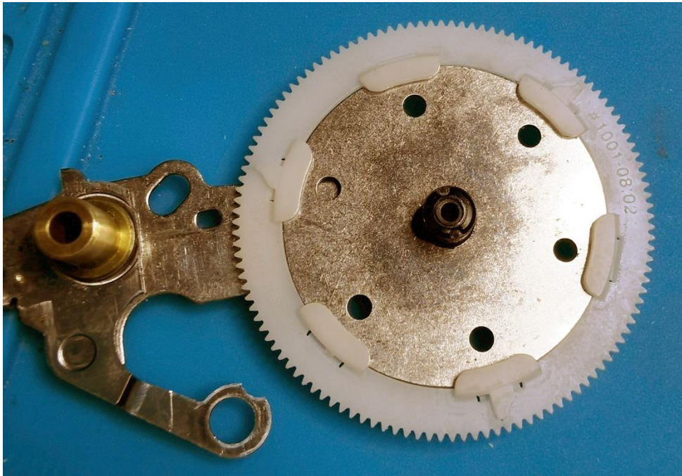
Bild 8 CenterGear Baugruppe Vorderseite
